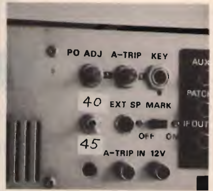
foto 2 Così va sistemato il deviatore nella parte posteriore dell'apparecchio. Le etichette adesive indicano solo prima modifica. Se si effettua la seconda, si deve aggiungere anche 28/27.
