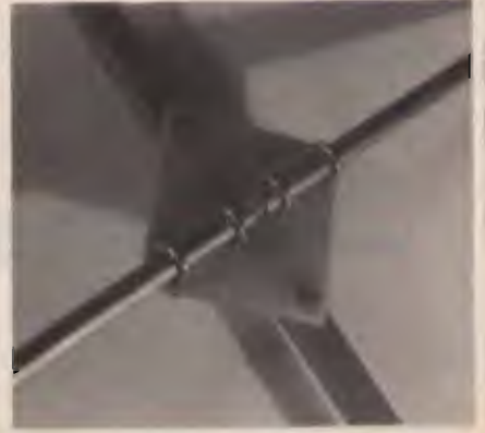
foto 3 Altro metodo per fissare gli elementi (escluso il radiatore) alla staffa e al boom. Notare le tegoline anti-schiacciamento.
