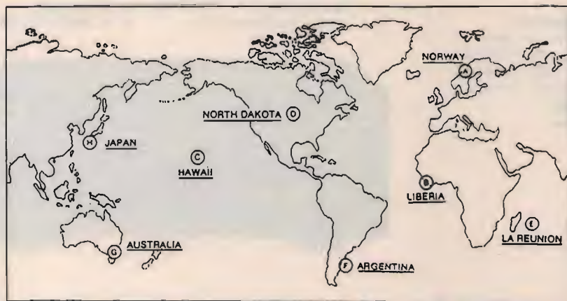
figura 1 Ubicazione delle otto stazioni del Sistema di Radionavigazione Omega nel mondo.
