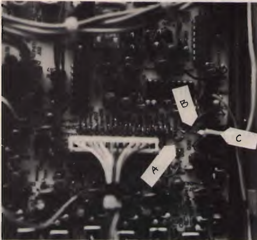
foto 1 Sezione della Control Unit dove si effettua la modifica. La freccia "A" indica il diodo D-04 tagliato. La freccia "B" il diodo DA-4 aggiunto e la "C" il filo "F" che va al deviatore.
