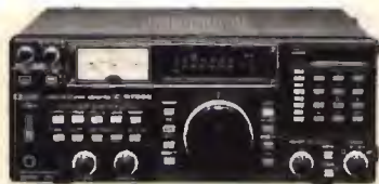
ICOM IC R7000 ricevitore a copertura continua VHF-UHF, 99 memorie
