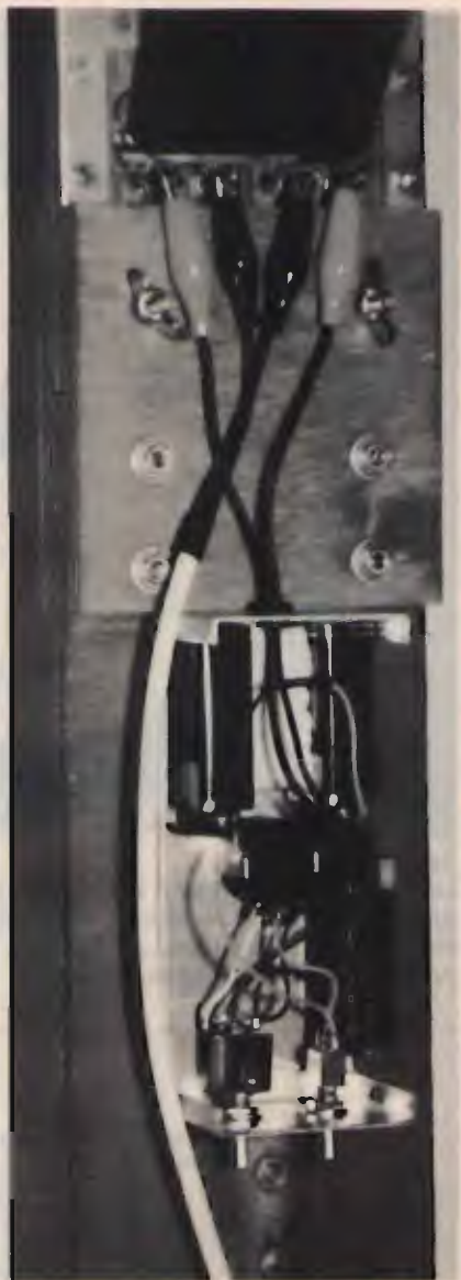
figura 5 La foto mostra la parte centrale dell'antenna, con le connessioni volanti al loop, il cavo coassiale che va al convertitore e il complesso di controllo dei varicap.
