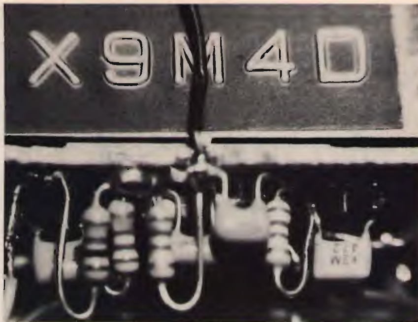
foto 2 Il filtro X9M4D da 4 kHz con i componenti installati direttamente sotto il suo corpo.
