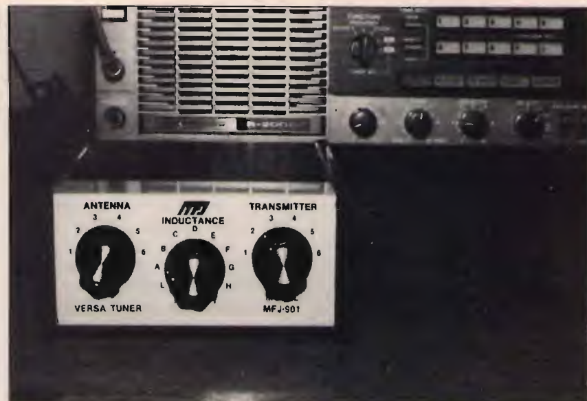
figura 4 Un semplice ed economico accordatore d'antenna.
