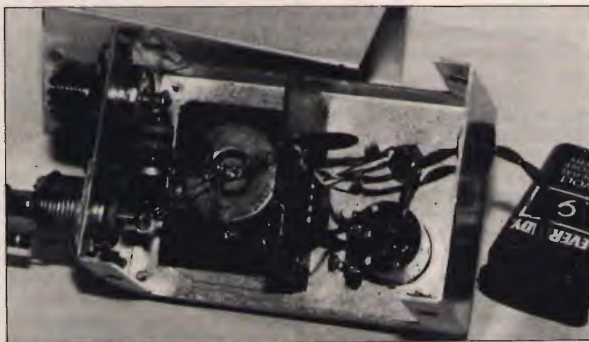
foto 1 "Vista interna dell'impedenzometro. Notate la disposizione compatta dei componenti. Se è previsto l'uso sulle VHF, la lunghezza dei collegamenti deve essere ridotta al minimo possibile".
