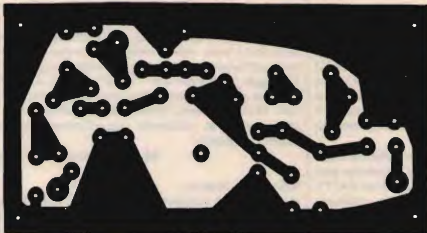
figura 5 Il circuito stampato, in grandezza naturale, dell'amplificatore RF di figura 4.
