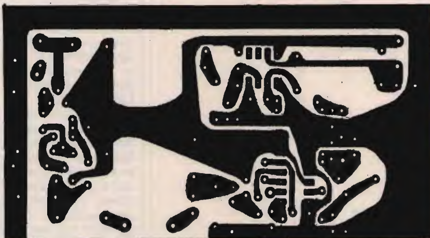
Circuito stampato del ricevitore per frequenza campione (scala 1:1), e disposizione dei componenti.
