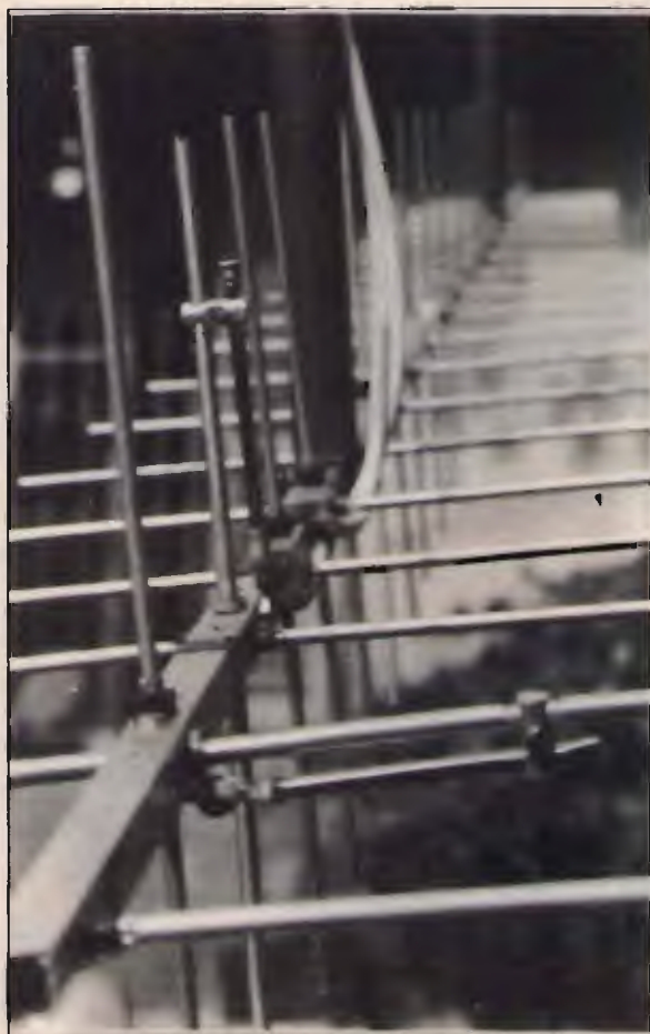
foto 1 Antenna UHF con doppia polarizzazione lineare (orizzontale e verticale) o circolare, costruita su boom a profilo quadrato.
