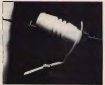
figura 5/A "Filo di collegamento per abbassare la frequenza di risonanza sui 160 metri".
