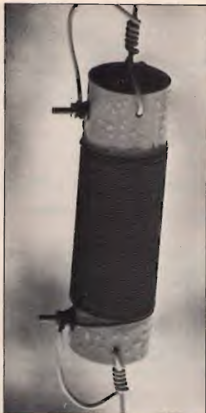
“La trappola per gli 80 metri è ricavata da un tubo in PVC del diametro di 3,75 cm”.
