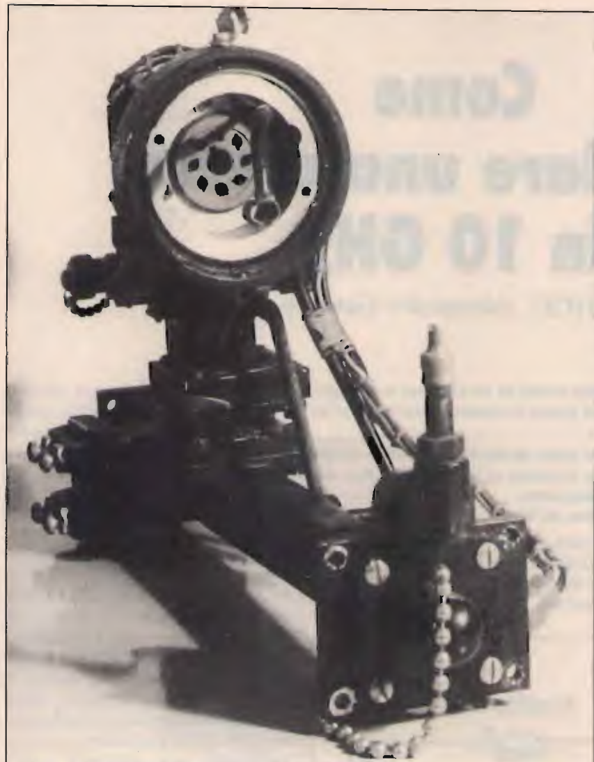
Altra immagine della unità A-106/APG-30. Sia il klystron 2K-25 che il relativo schermo sono stati tolti per evidenziare la posizione del klystron rispetto alla guida d'onda oscillatore locale, e quest'ultima rispetto a quella mixer.
