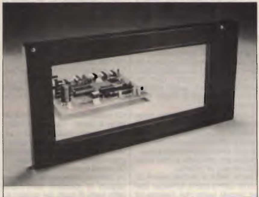
figura 3 "Un visore a contatto con, sullo sfondo, il circuito elettronico che ne consente il funzionamento".
