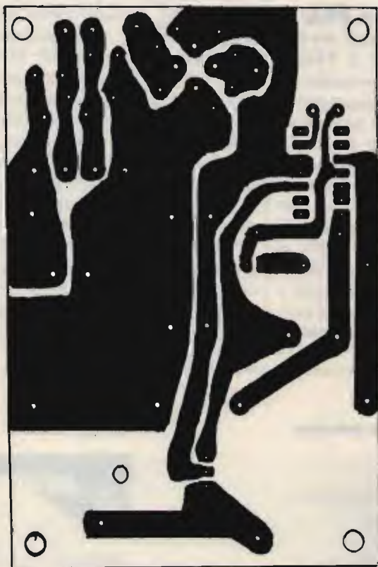
Lato rame 1:1 dello stampato della piastra alimentatore del DX 10.
