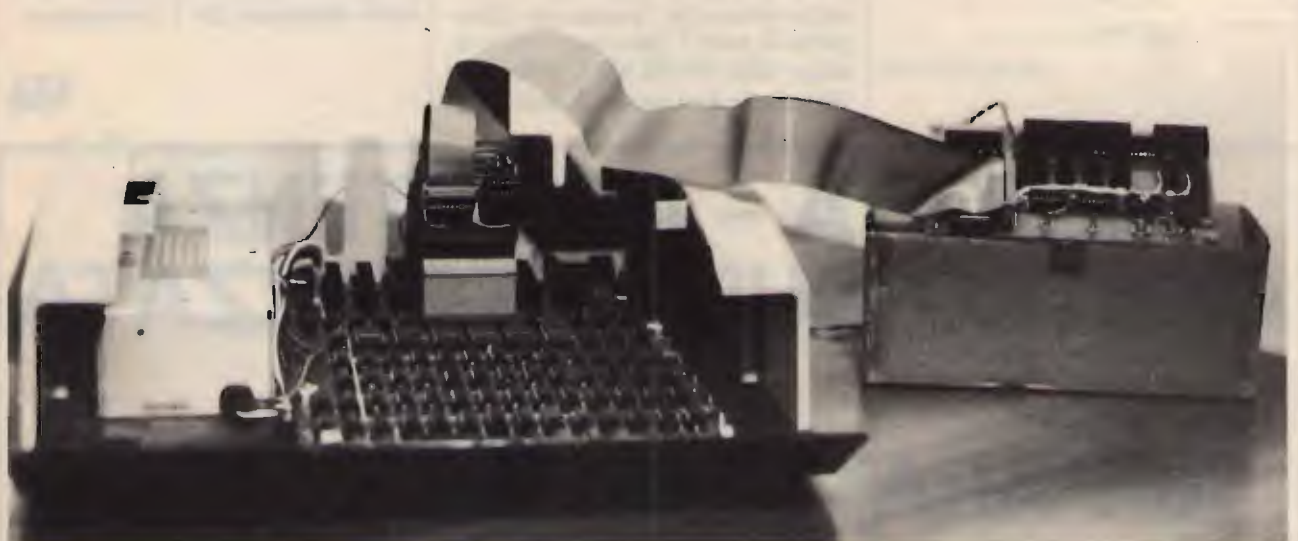
foto 8 Esempio di utilizzo su un personal computer; l'alimentazione dell'apparato è ricavata dall'alimentazione del personal.
