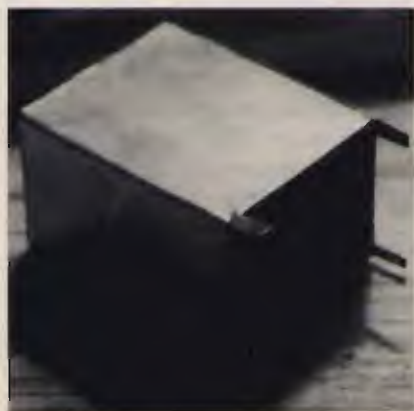
foto 6 Schermo metallico ricavato da un sottile lamierino di "latta" zincata (per RL 1 ).
