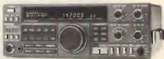
TS 440 S Ricetrasmittitore HF - Copertura continua AM-FM-CW-SSB 220 W P.e.P.
