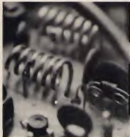
foto 5 Le bobine sono tutte avvolte in aria. Alcune sono dotate di presa alla seconda spira.
