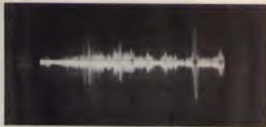
foto 8 Ruotando il nucleo di L_2 si otterrà lo scorrimento orizzontale della banda analizzata.
