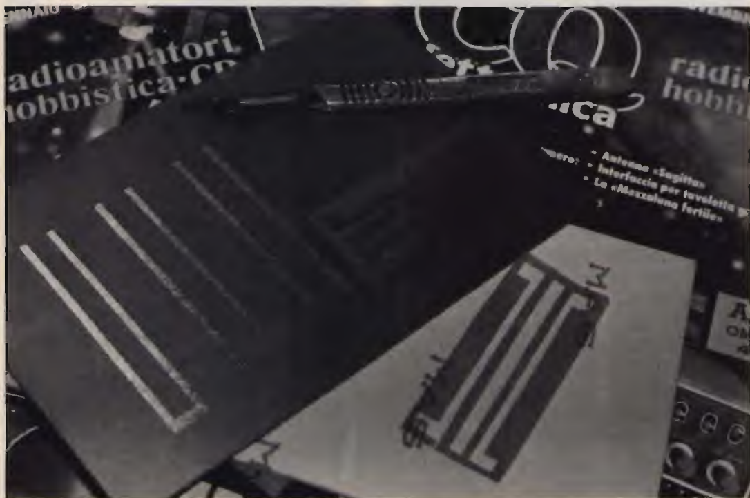
Circuito stampato di un filtro passabanda per i 432 MHz con linea per misure di ROS.
