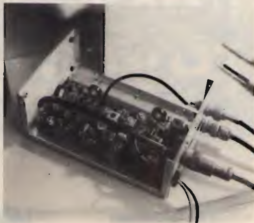
foto 4 Disposizione del circuito stampato all'interno del mobiletto metallico contenitore.
