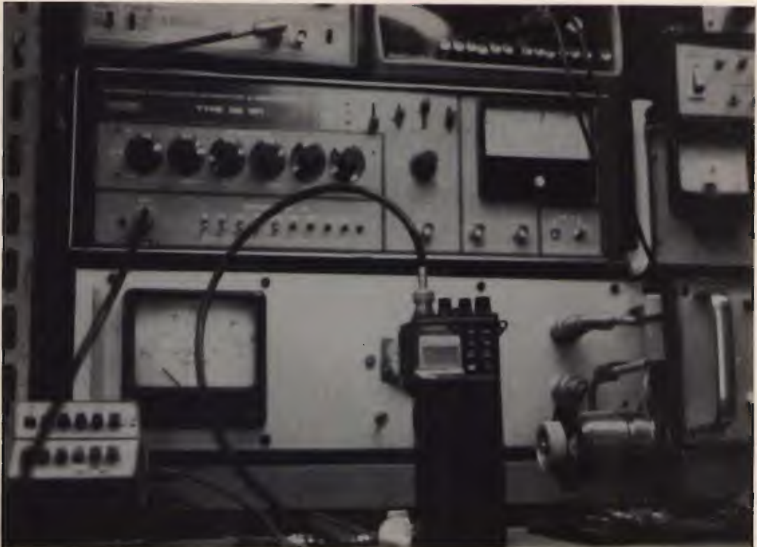
foto 5 Si prova la sensibilità con il generatore.
