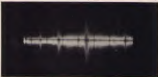
foto 5 Segnale inviato all'oscilloscopio direttamente prelevato dal secondario di MF3.
