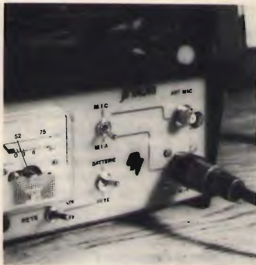
Si sta misurando l'impedenza, corretta in questo caso, di una Ground-Plane per i 27 MHz.
