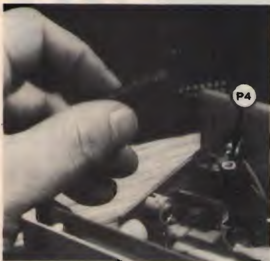
Chi lo desidera potrà sostituire P_4 con un trimmer multigiri: ciò renderebbe più facile le operazioni di taratura del ponte.
