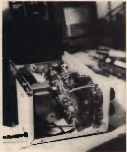
Il Beta Tauri risulterà un apparecchio molto compatto se avremo cura di posizionare con criterio i vari telaietti che lo compongono.
