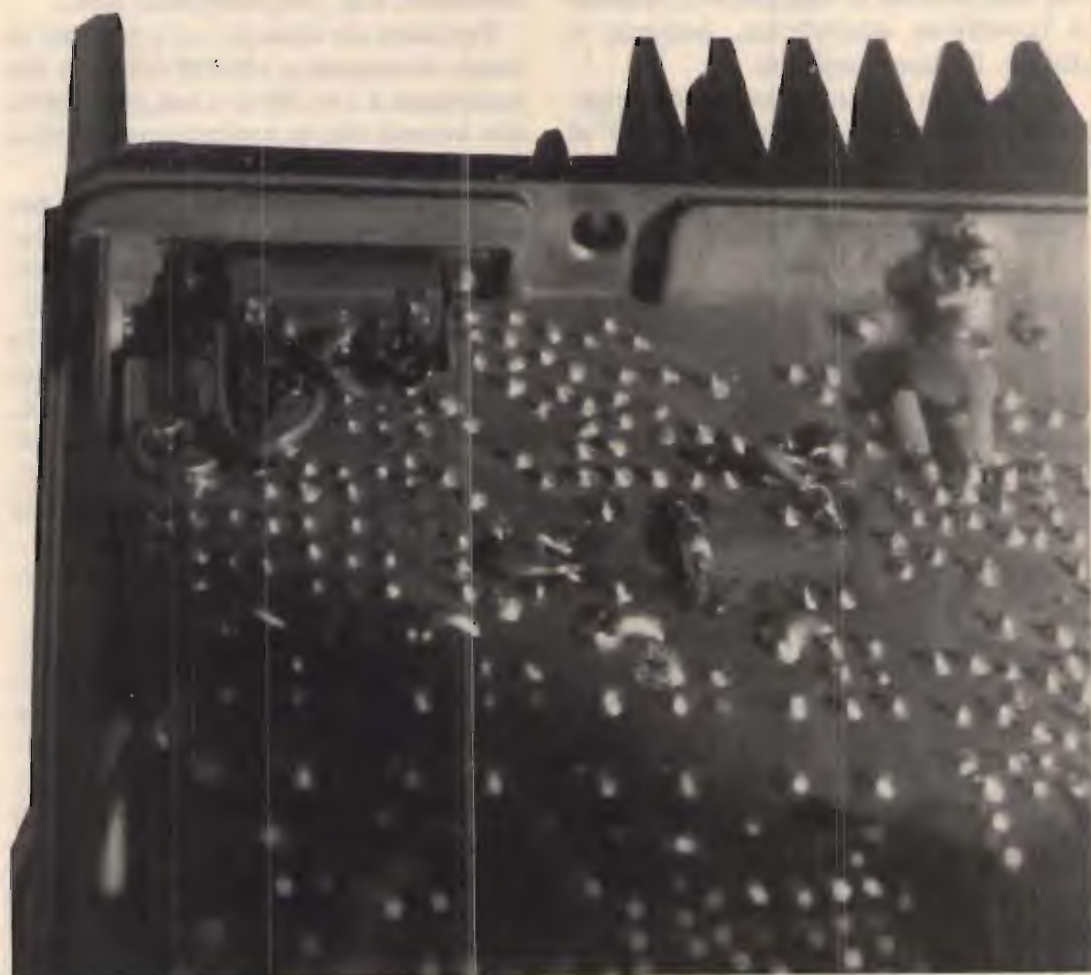
Questo è l'interruttore del "Tone Burst", che servirà per le varie modifiche. I fili che si vedono furono saldati durante i vari test di prova. La versione definitiva è quella rappresentata nel disegno pubblicato a parte.
