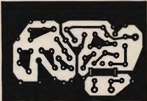
Circuito stampato. Scala 1:1 - Questo stampato può essere riprodotto FACILMENTE. Si veda CQ n. 4/83 pagina 45 per il procedimento.
