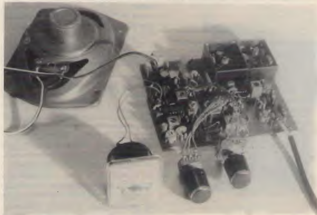
Il ricevitore "Rho Ophiuchi" già assemblato nei suoi cinque telaie e pronto a funzionare.
