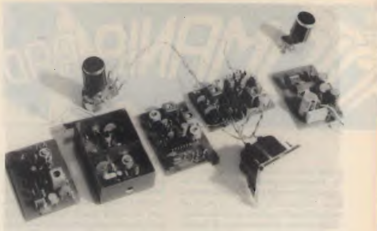
I cinque moduli del ricevitore "Rho Ophiuchi" prima di essere assemblati in un unico circuito.
