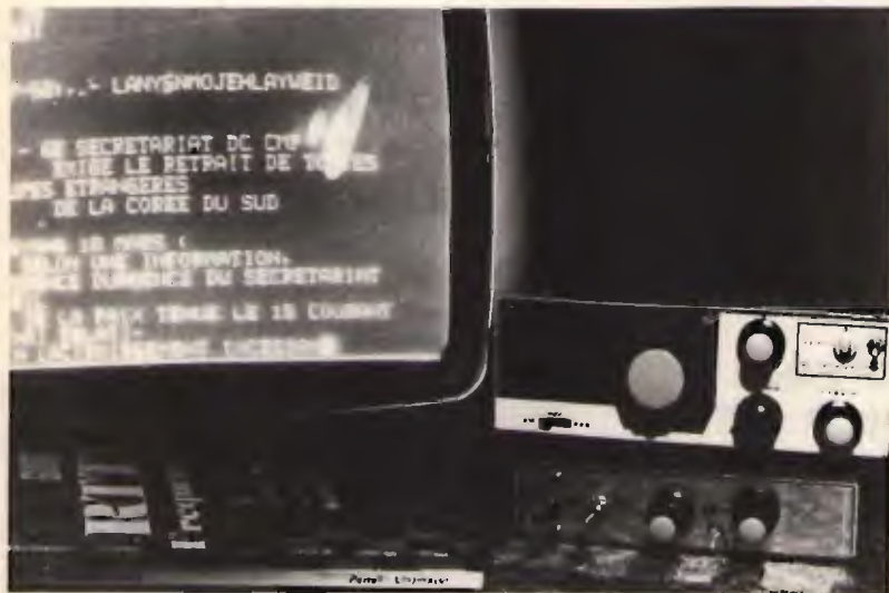
Collaudo del converter con la sincrodina a 14 MHz nella ricezione RTTY di Agenzie Stampa.
