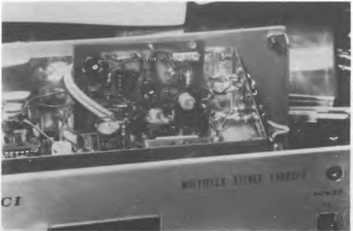
Montaggio all'interno dell'encoder a basetta ultimata.
