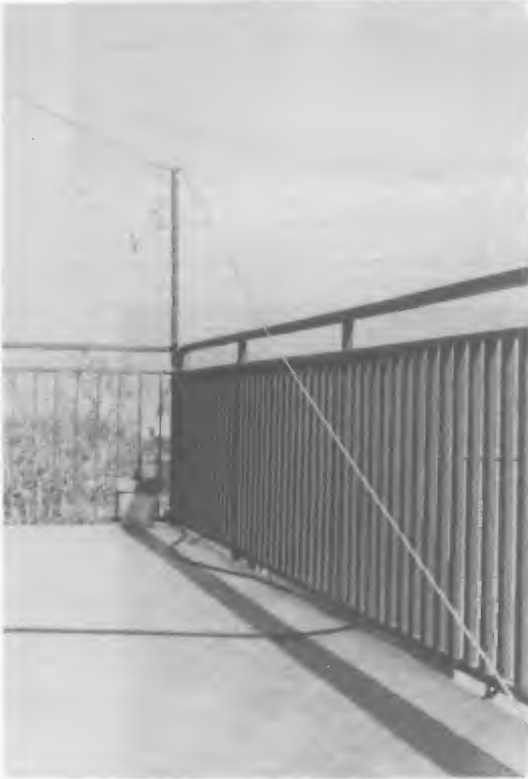
Attacco angolare del dipolo 80 m.
