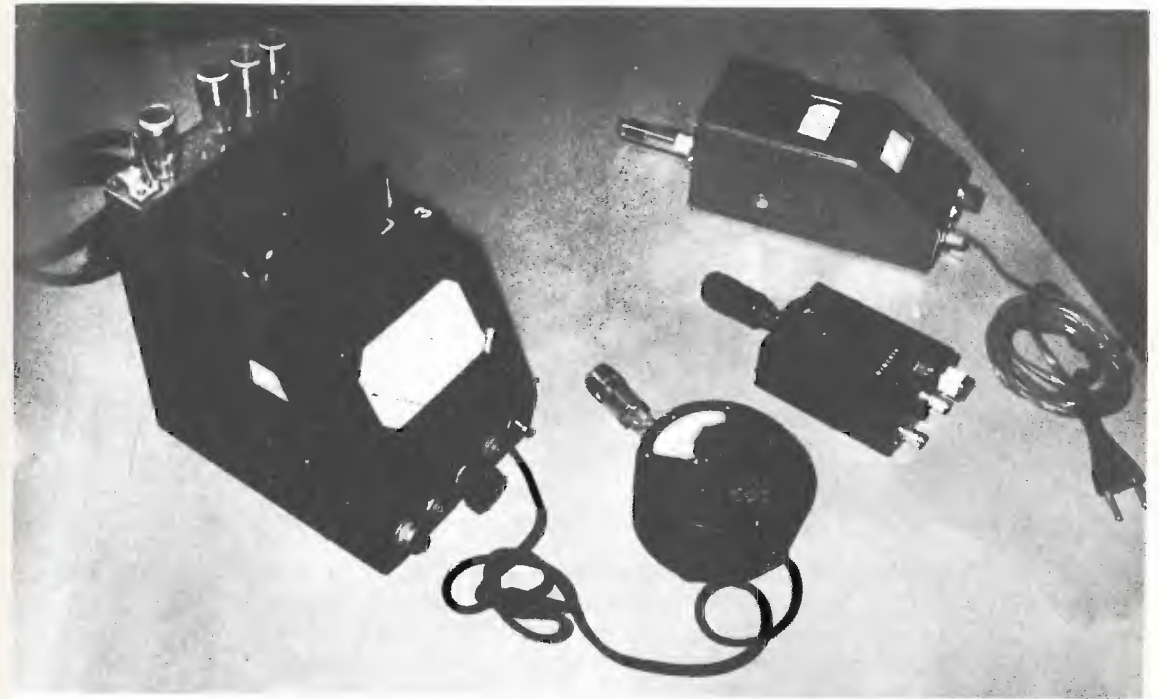
Le dimensioni del minidip risaltano dal confronto con due suoi cugini: a sinistra un vecchio grid-dip a testa esploratrice; e a destra un moderno grid-dip americano.
