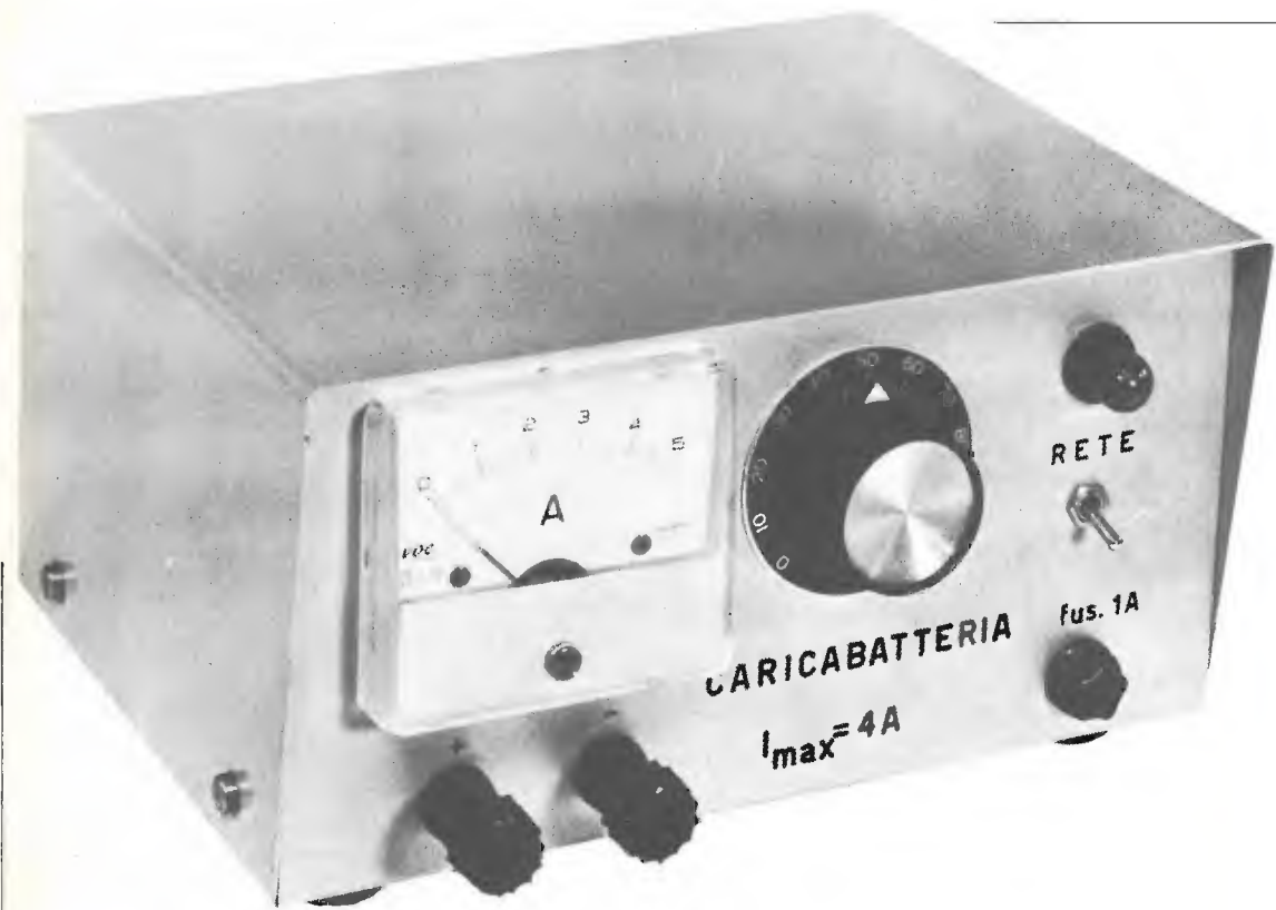
Vista frontale del carica-batterie. La manopola graduata regola la corrente di ricarica.
