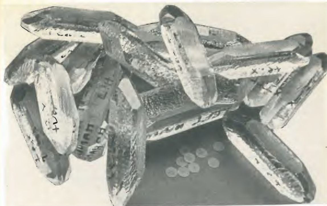
Un gruppo di cristalli di quarzo prima del taglio. I dischetti al centro della foto sono lamine di cristallo già tagliate.
