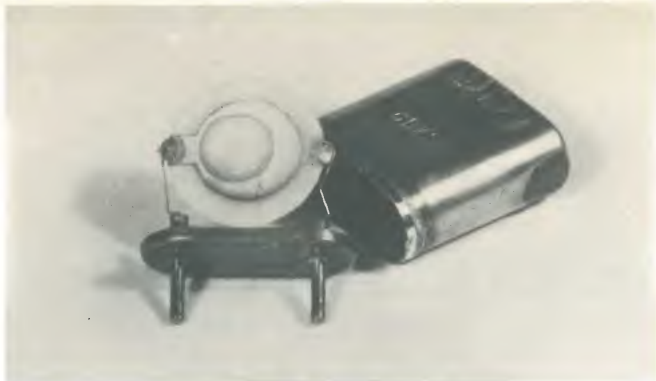
Un cristallo aperto: per aprire i cristalli, basta far sciogliere lo stagno su una fiamma a gas. Il cristallo della fotografia aveva smesso di oscillare perché la piccola saldatura di sinistra era difettosa, come si può vedere dalla fotografia.
