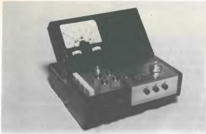
FOTO 2 - STRUMENTO IN POSIZIONE DI LAVORO CON UN "CASSETTINO" INSERITO. SI NOTI LA POSIZIONE SOLLEVATA DELLO STRUMENTO PER AGEVOLARNE LA LETTURA (MICROAMPEROMETRO).
