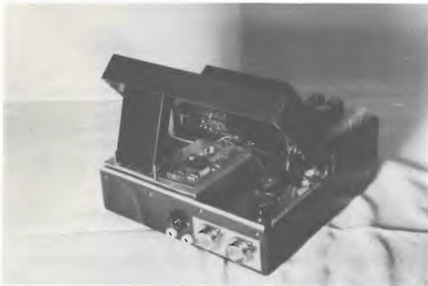
FOTO 3 - LO STRUMENTO VISTO DAL LATO POSTERIORE. SONO VISIBILI, NELL'INTERNO, IL CIRCUITO STABILIZZATO DELL'ALIMENTATORE AUSILIARIO CON NEGATIVO A MASSE E IL RELATIVO ZN3055 MONTATO SU DISSIPATORE. ALL'ESTERNO I ZN3055 DEGLI ALIMENTATORI PRINCIPALI, IL CAMBIO TENSIONE E L'INGRESSO DELLA C.A.
