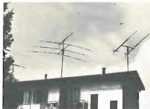
Antenne I2SRR 3 elementi tribanda (10-15-20 m) 11 elementi FR 144 ÷ 146 MHz 11 + 11 elementi FR 144 ÷ 146 MHz W3DZZ multibanda
