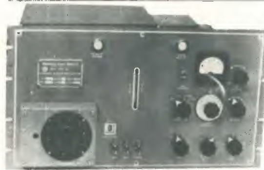
Oscillatore Northern Radio 115 VFO che fornisce una maggiore stabilità e un allargamento di banda quando viene usato con un ricevitore SP600.
