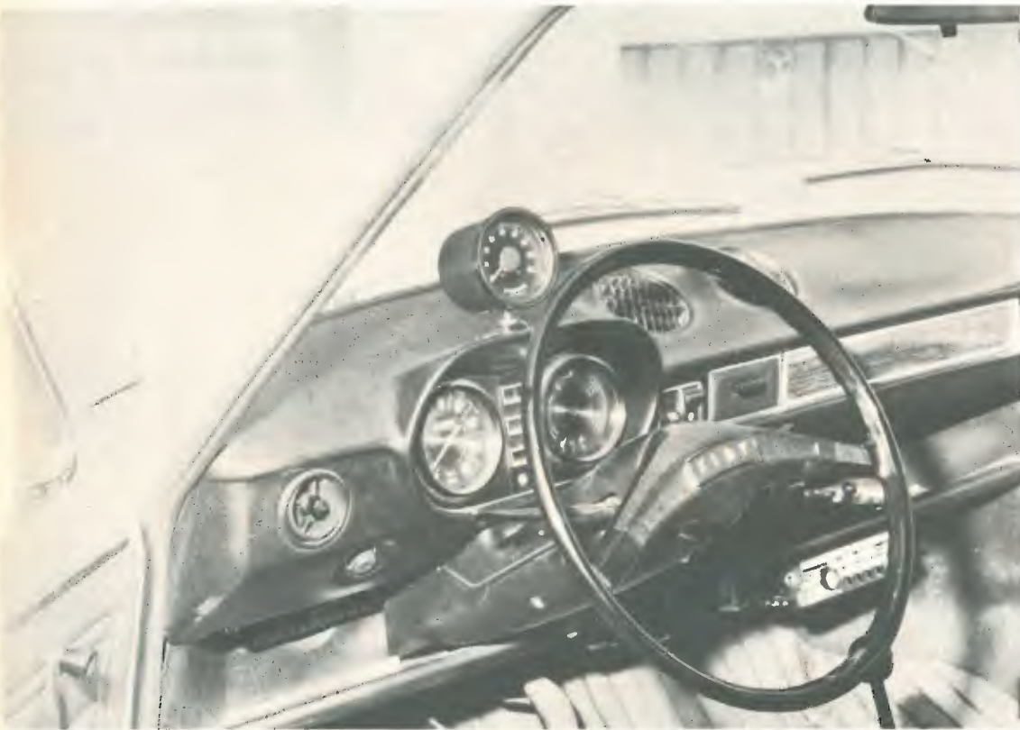
Il contagiri è stato provato per alcune centinaia di chilometri su un motoveicolo (Suzuki GT380) prima di essere messo definitivamente su di una autovettura (Fiat 128 Berlina).
