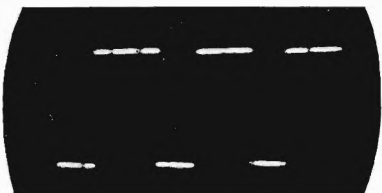
Andamento della tensione all'uscita del trigger, con ai morsetti collegato un condensatore uguale al doppio del fondo scala impostato (come si vede esiste ancora margine di linearità).
