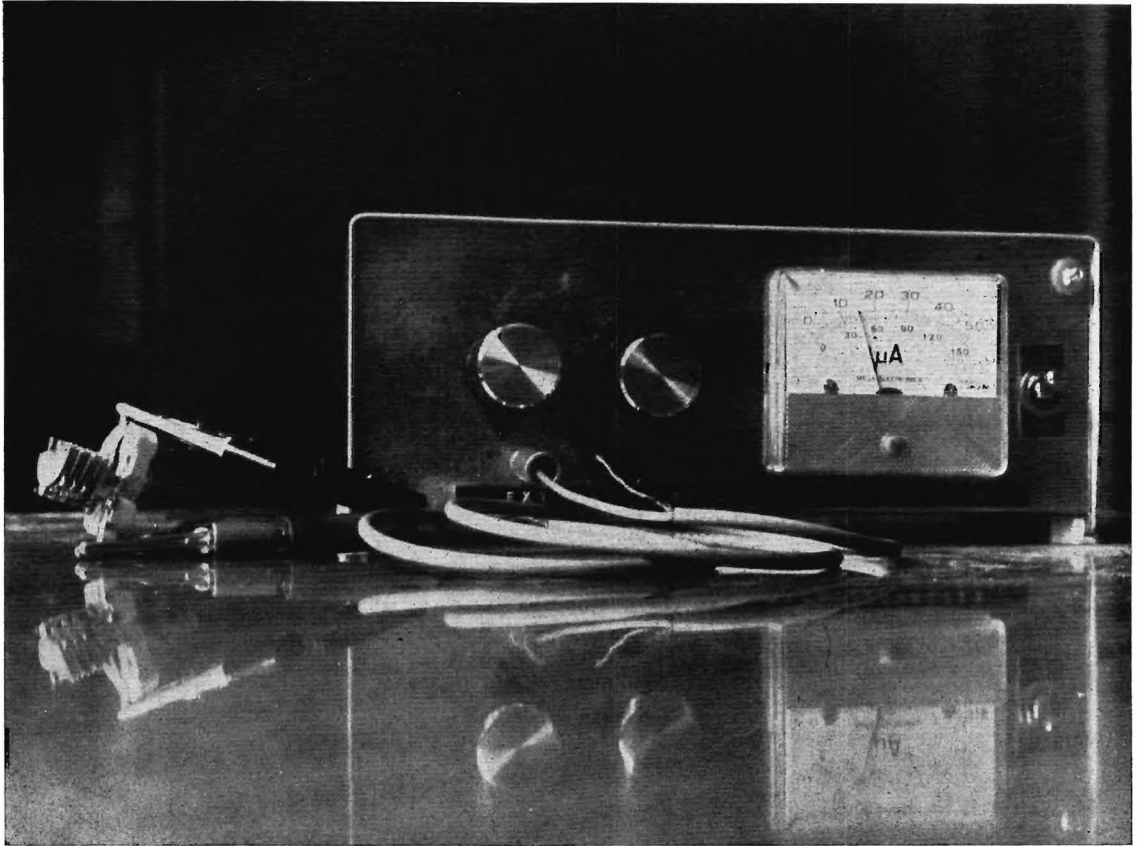
Misura di un piccolo variabile per VHF da 15 pF. La misura è esatta nonostante la capacità del cavo (circa 90 pF).
