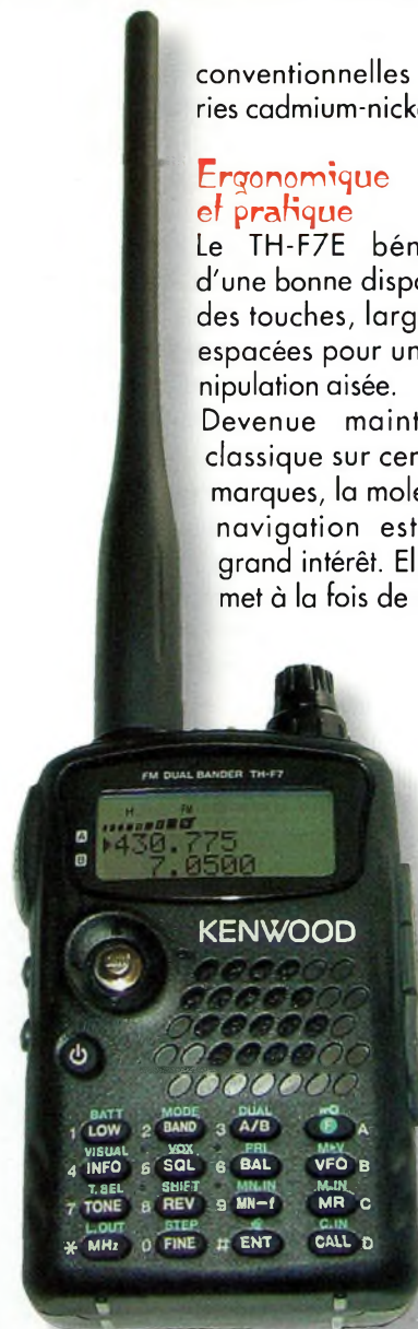
Un appareil de poche qui ouvre la voie de la réception multi-mode de 0.1 à 1300 mégahertz, avec en plus, un transceiver 144 et 432 MHz.
