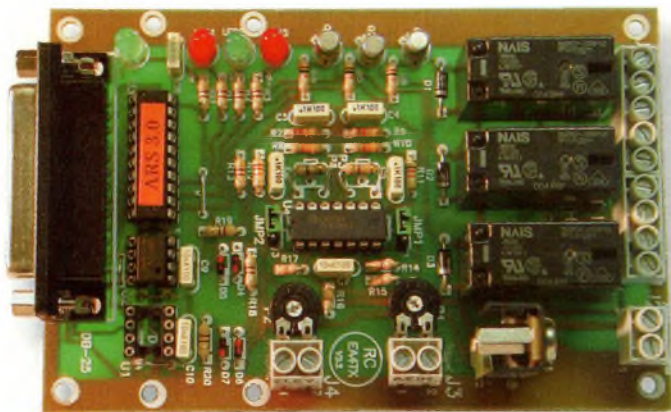
Les borniers reçoivent la connexion des fils du rotor. Notez les quatre LED qui affichent le sens dans lequel tournent les antennes.
