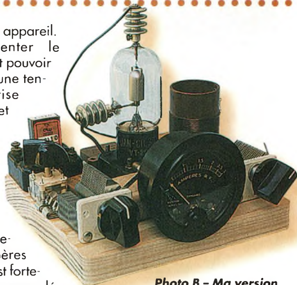
Photo B - Ma version rapidement élaborée du rig Remarkable Retro 3C24 est construite sur une minuscule planche en pin mesurant 2,5 x 15 x 15 cm. La disposition générale des pièces n'est pas très importante et peut varier pour l'esthétique. (Photo de WØFEV)
