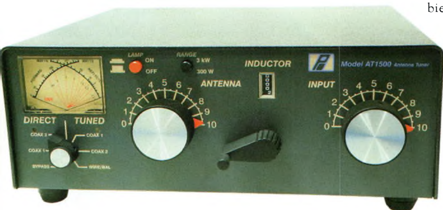
Un bon coupleur est nécessaire la plupart du temps lorsqu'il s'agit d'antennes "raccourcies". Pensez à opter pour un coupleur à sortie symétrique (ligne bifilaire).
