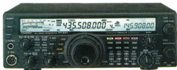
Polyvalents, les transceivers modernes, comme le Yaesu FT-847, proposent les bandes HF, VHF/UHF ainsi que le 50 MHz dans un seul coffret.
