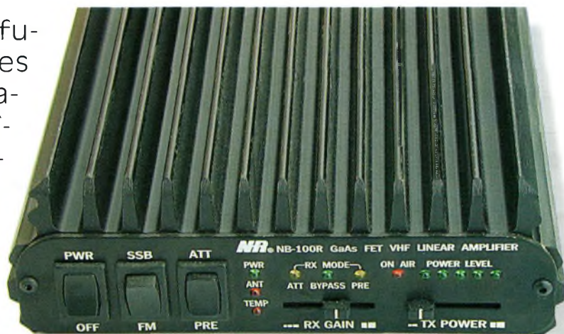
la face avant du NB-100R est très complète et présente de nombreux réglages.
