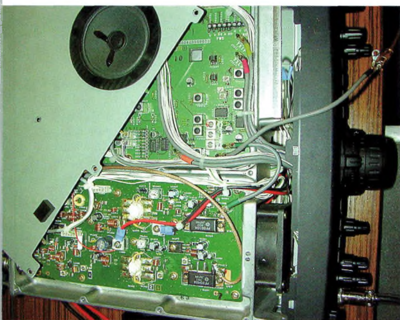
Une vue « aérienne » de l'intérieur du FT-847 et le câble gris là droitel qui part vers l'entrée du modulateur. La partie supérieure de l'image montre qu'il est possible d'intégrer le module définitif dans le transceiver.
