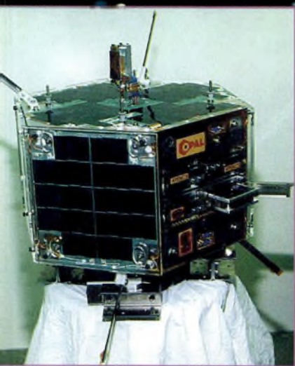
Le lanceur OPAL est un microsatellite chargé de mettre sur orbite plusieurs picosatellites, dont STENSAT, un satellite radioamateur.
