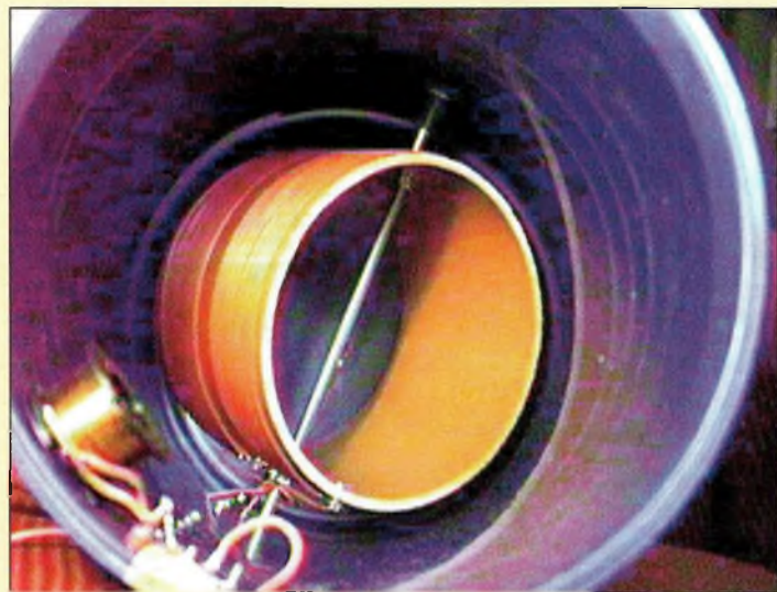
Le variomètre est indispensable si vous ne parvenez pas à installer une antenne de taille adéquate.
