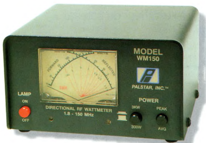
Un ROS-mètre doit toujours être connecté dans la ligne d'alimentation de l'antenne.
