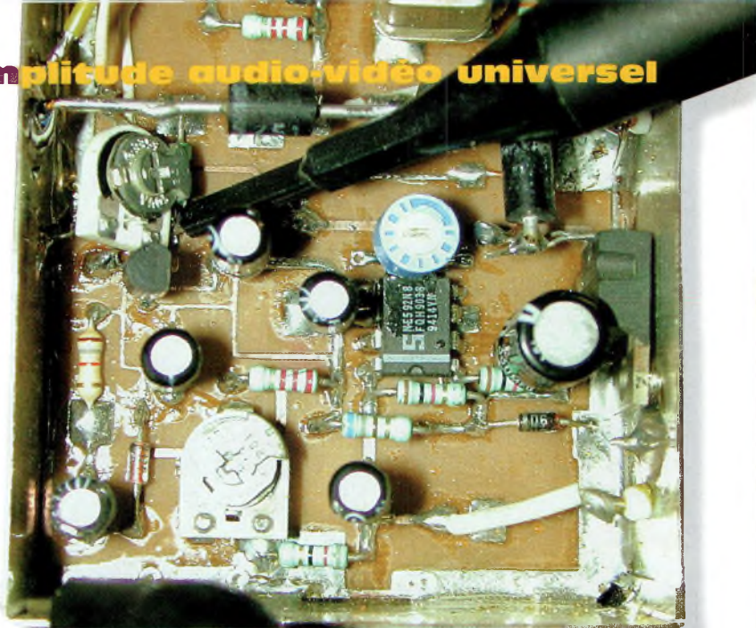
Un vieil émetteur de télévision « maison » a été remis en service pour utiliser ses étages vidéo. Il est équipé d'un alignement sur le niveau des noirs et peu de modifications furent nécessaires pour l'adapter à nos besoins.
