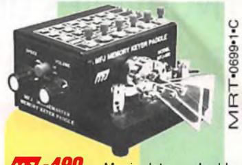
**MFJ-490** Manipulateur double contact. Générateur de messages commandé par menu. Alimentation pile 9 V ou adaptateur 12 Vdc.
