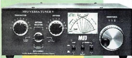
**MFJ-989C** Coupleur 1,8 à 30 MHz. 3000 W. Watt/ROS-mètre à aiguilles croisées 200/2000 W, éclairage cadran 12 Vdc. Self à roulette. 2 sorties coax + 1 sortie long fil + 1 sortie ligne. Charge 300 W incorporée.
