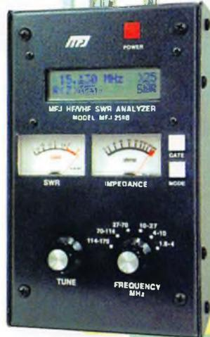
**MFJ-259B** Générateur analysant le ROS de 1,8 à 170 MHz. Fréquence LCD 10 digits + affichage par 2 galvanomètres du ROS et de la résistance HF. Mesure des impédances complexes (résistance et réactance ou amplitude et phase). Prise SO-239. Entrée BNC séparée pour utilisation en fréquencesmètre. Alimentation piles ou adaptateur secteur.
