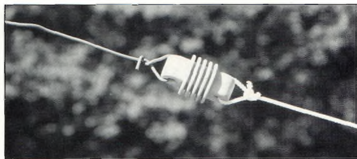
A l'extrémité des deux antennes, des isolateurs dignes de ce nom offrent un point d'attache solide.
