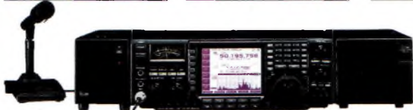
Photo du prototype IC-756 avec PS-85 (alimentation externe en option), SM-20 (micro de table en option) et SP-21 (HP externe en option).
