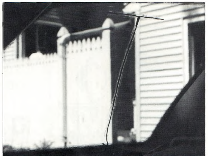
L'antenne elle-même est fixée à la vitre au moyen de Scotch®.
