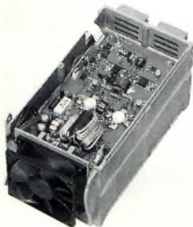
Le bloc «PA» qui délivre jusqu'à 200 watts.
