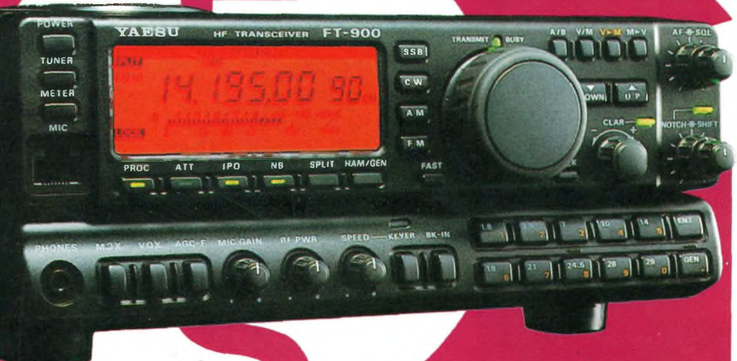
EMETTEUR/RECEPTEUR MOBILE DECA METRIQUE FACE AVANT DETACHABLE
