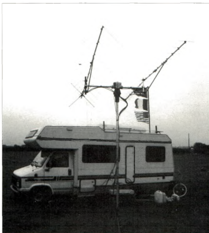
Cette installation comportant une antenne VHF et une antenne UHF, pourra opérer en mode B et en mode J.
