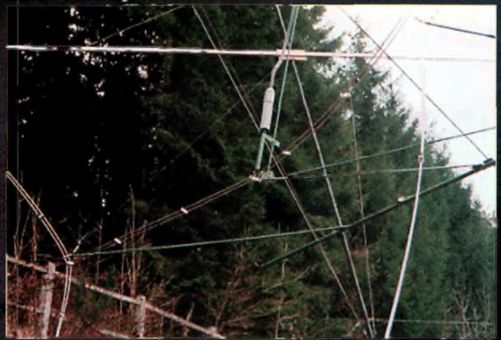
Zoom sur les lignes de couplage 200 ohms chez F3VS.
