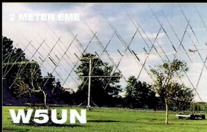
La carte QSL de W5UN avec la photo de ses antennes EME 144 MHz.
