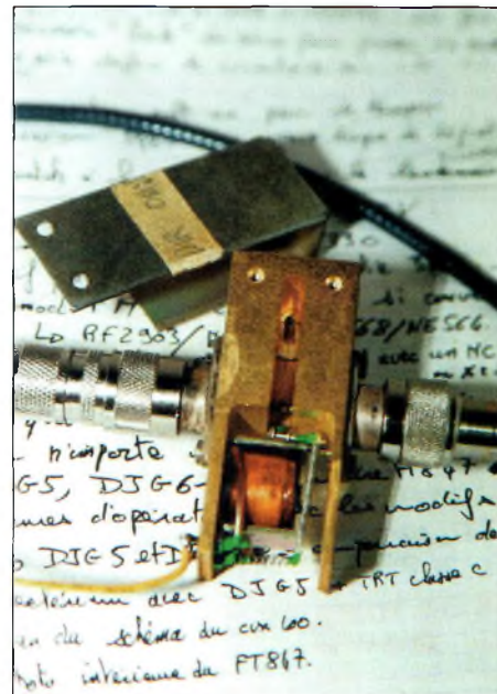
Vue intérieure d'un relais coaxial.
