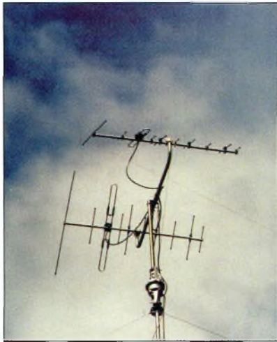
Les antennes d'émission et de réception utilisées en ATV.
