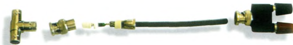
A l'autre bout, un adaptateur BNC/Banane finit le raccord en «T» proprement.
