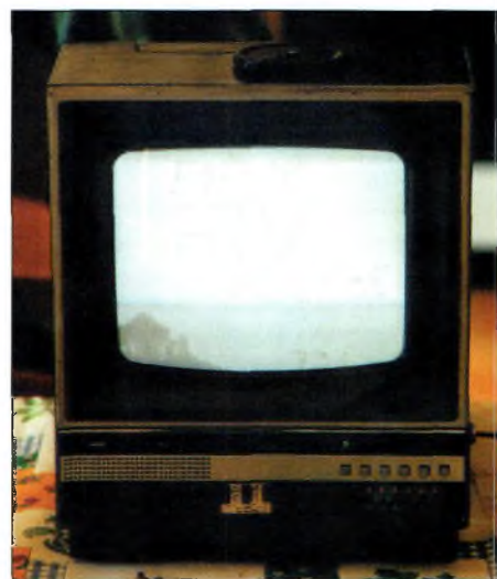
Le résultat de la modification du téléviseur : l'image n'est pas assez contrastée.
