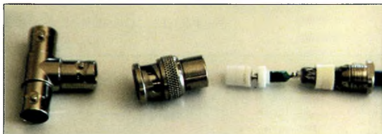
L'insertion d'une inductance dans la fiche BNC.
