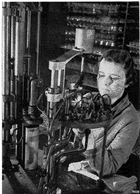
Fig. 68 Om den roostertoevoerdraad door den top van den ballon naar buiten te brengen, wordt op deze plaats aan den ballon een dun glazen buisje aangesmolten.
