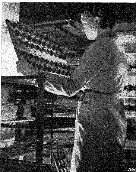
Fig. 69 Ter keuring van den ballon houdt men dezen tegen een verlicht matglas.
