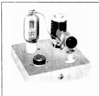
FIG. 20 35T Triode Oscillator.
