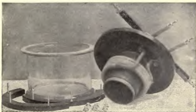
FIG. 233.—BRAUN TRANSFORMER. (Dissected.)
