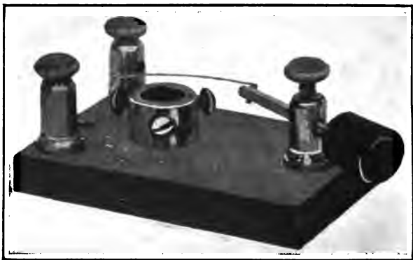
Fig. 23.—A Simple Crystal Detector.
