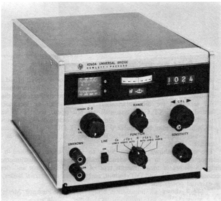
Fig. 5-7. Portable impedance bridge with automatic DQ balance.
