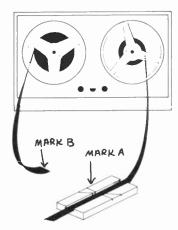
NOW MOVE THE TAPE IN THE SLOT TO MARK A. MAKE YOUR DIAGONAL CUT. DISCARD THE WASTE TAPE.
