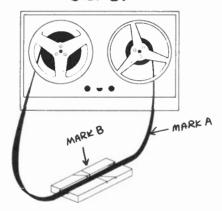
NOW PRESS THE TAPE INTO THE GROOVE OF THE EDITING BLOCK, SHINY SIDEUP. MARK B SHOULD BE EXALTLY OVER THE SLOT THAT RUNS DIAGONALLY ACROSS THE BLOCK. CUTTHETAPE ALROSS THE PIAGONAL SLOT WITH YOUR RAZOR. THERE IS ALSO A SLOT RUMNING STRAIGHT ACROSS THE BLOCK, BUT THIS IS USED ONLY WHERE EXTREME ACCURACY IS NECESSARY, SINCE THE SPUCE IT MAKES ISN'T AS STRONG AS THE DIAGONAL ONE.
