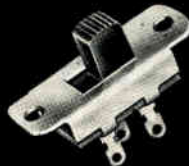
SS-32 SP-DT, 1-amp. @ 125v ac-dc. U.L. Inspected.
