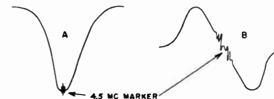
Fig. 23. Audio I-F Curve
