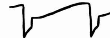
PIN 5 (V12) 6CD6G HORIZ. OUTPUT 65 VOLTS PP
