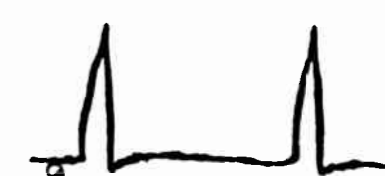
PIN 9 T4 HORIZ. WIDTH COIL 250 VOLTS PP
