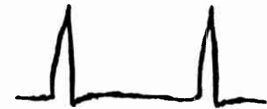
PIN 5 T4 HORIZ. WIDTH COIL 250 VOLTS PP
