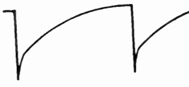
PIN 5 (V12) 6CD6G HORIZ. OUTPUT 65 VOLTS PP
