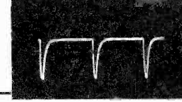
4 HORIZ. RATE 60V P-P V201B PIN 1 SYNC PLATE
