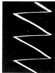
17 HORIZ. RATE 1 V P-P ANODE SR501-C555 HORIZ. PHASE DETECTOR
