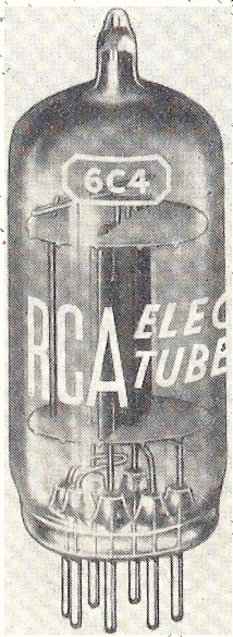
Fig. 1. RCA miniature 6C4
