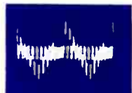
34 A701-4 7V P-P Horiz. Rate Demod Output
