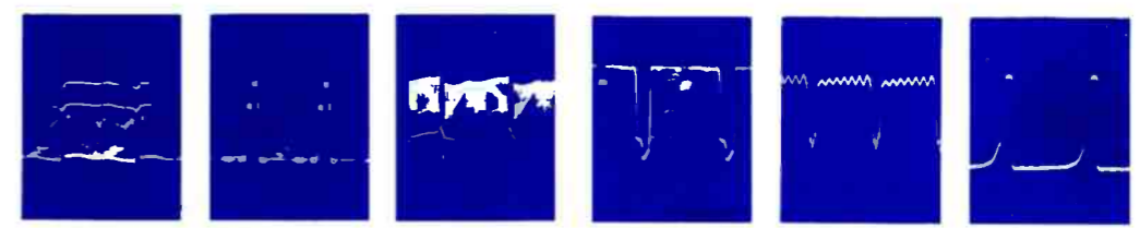
1 4.95V p/p 60Hz 2 4.95V p/p 15,750Hz 3 40.5V p/p 60Hz 4 3.8V p/p 60Hz 5 12.5V p/p 60Hz
