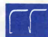
5 V201-1 HORIZ. SYNC PULSE 50V. P-P HORIZ. RATE
