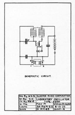
Fig. 4. The wiring diagram
