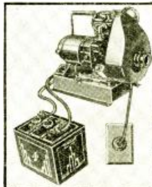
A 300-W. power plant. (1109)
