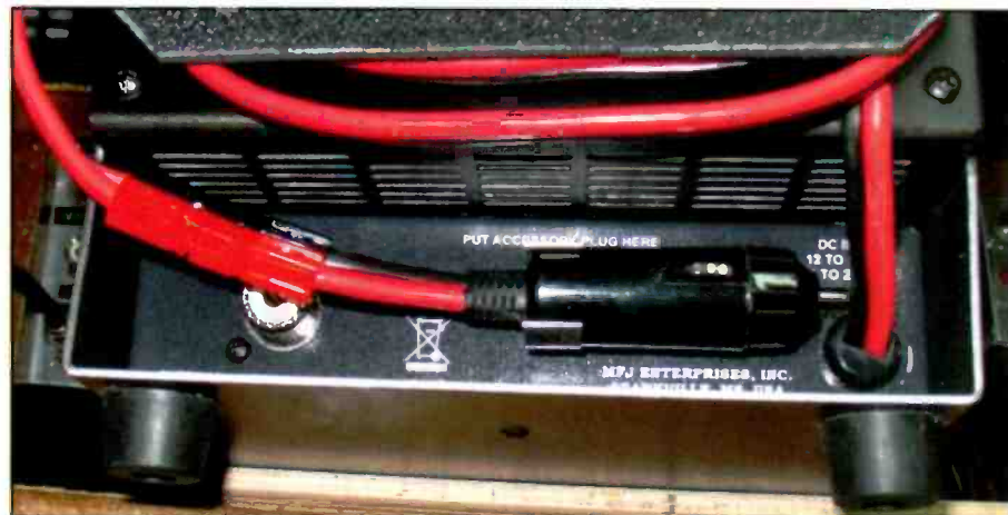
Photo E. Modified pendant cable.
