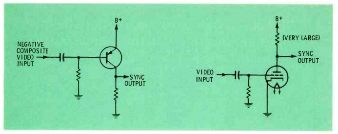
Fig. 4 Sync separator for negative video.
