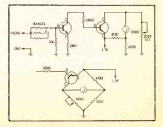
Fig. 16. Simplest transistor voltmeter.
