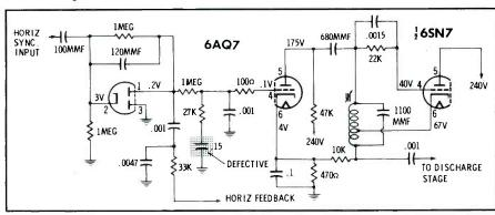
Fig. 1. Gruen horizontal AFC circuit.
