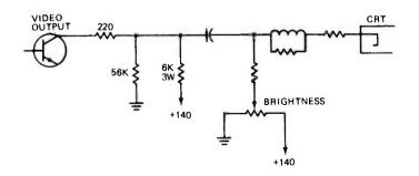
FIGURE 3. VIDEO AMPLIFIER OF TRUETONE HYBRID RECEIVER. SOUND AND RASTER BUT NO PICTURE DUE TO LACK OF COLLECTOR VOLTAGE FOR THE VIDEO OUTPUT TRANSISTOR.
