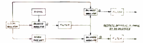
Fig. 1—90° phase shifter.
