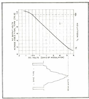
FIG. 7. CALIBRATION OF THE MODULATION PERCENTAGE
