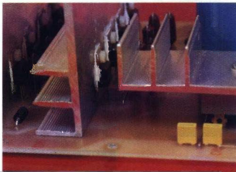
VUE SUR T_1 , LE TRANSISTOR DE COMMANDE DES RÉGULATEURS.
