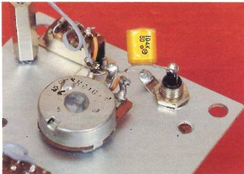
Photo 3. - La résistance R_{11} et le condensateur C_9 sont câblés sur la face avant.
