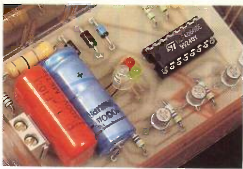
Photo 3. – Les trois diodes électroluminescentes placées dans un trou de forme triangulaire.
