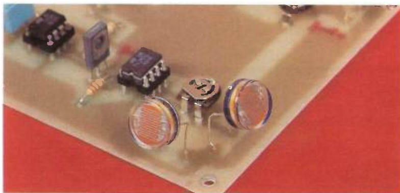
Photo 4. — Les résistances LDR actionnent les amplificateurs opérationnels pour les changements de direction.
