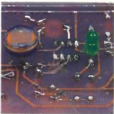
Photo 2. — Vue du côté circuit imprimé, avec la DEL et la LDR.
