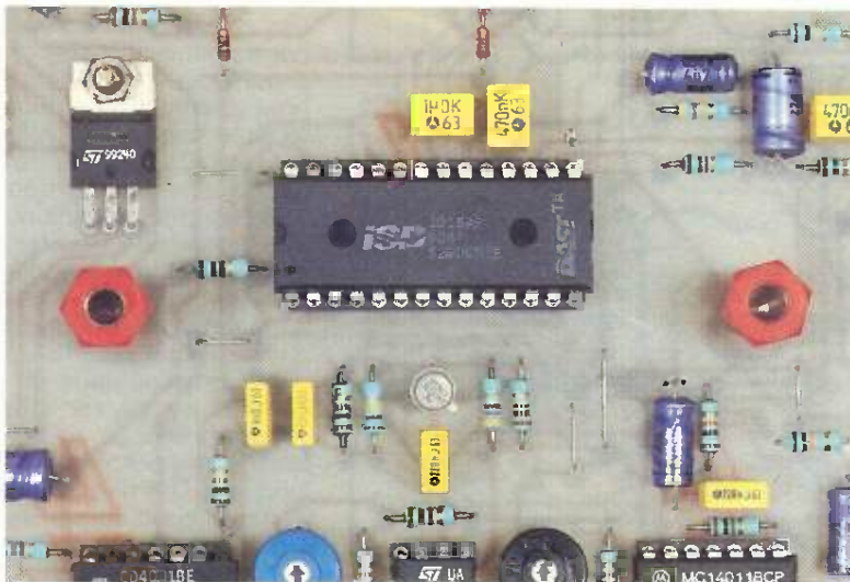
Photo 3. - Les fiches banane pour la connexion du haut-parleur.
