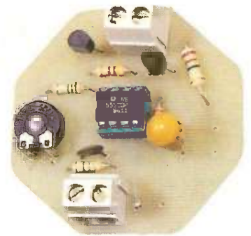
Photo 4. - Le carillon 3 notes fonctionne à l'aide d'un SAB 600.
