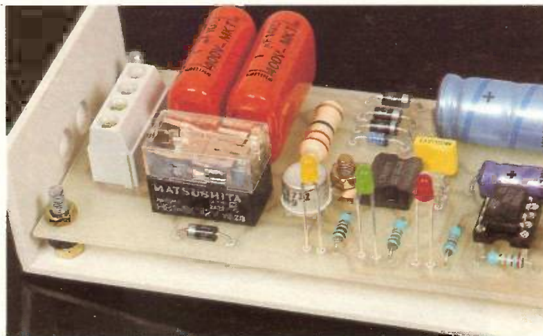
Photo 2. — Les relais miniatures de la série HB.
